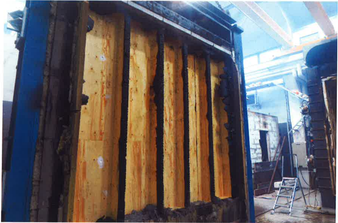
Kuva 13. Koekappale kokeen jälkeen
